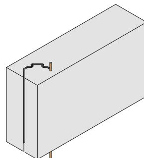
Kontur in den Stempel erodieren (G7-Toleranz)
