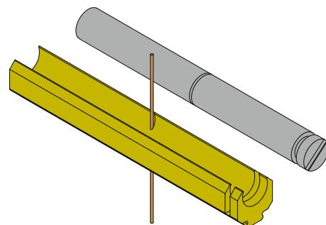
Rollbieger auf benötigte Länge mittels Drahterodieren ablängen (Rolle und Halter separat)
