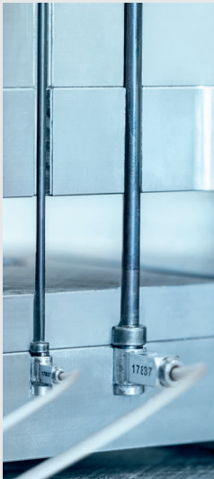
WERKZEUGINNENDRUCKSENSOREN - INDIREKT CAVITY PRESSURE SENSORS - INDIRECT
