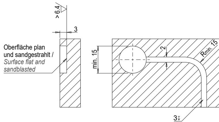
Sensor mit Sekundenkleber einkleben und mit PUR-Masse vergießen / Glue sensor in place with instant adhesive and mould with PUR compound
