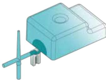
1. Hohe Einspritzgeschwindigkeit zum Füllen des Kaltverteilers
