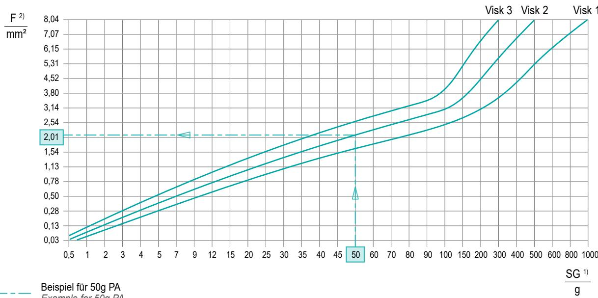
**Achtung:** Bei Verwendung von gefüllten Kunststoffen (**Glasfaser, Kohlefaser etc.**) die mit der Tabelle ermittelten Werte der Anschnittfläche um ~25% vergrößern! (E 1693, E 16935 und E 1694 nicht geeignet für gefüllte Kunststoffe)
